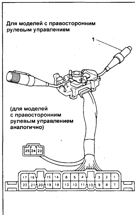
1- переключатель управления стеклоочистителем и омывателем лобового стекла
